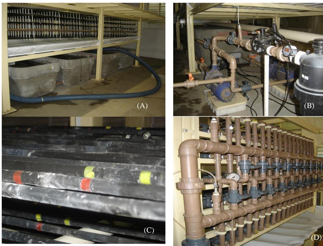
**Figura 1.** Detalhe do sistema de abastecimento da bancada, (A) caixas para o preparo das águas com os ISL; (B) sistema de condução da água e motobomba; (C) gotejadores marcados para leituras de vazões manuais; (D) entrada da linha de gotejadores e manômetro para aferição da pressão de serviço.
