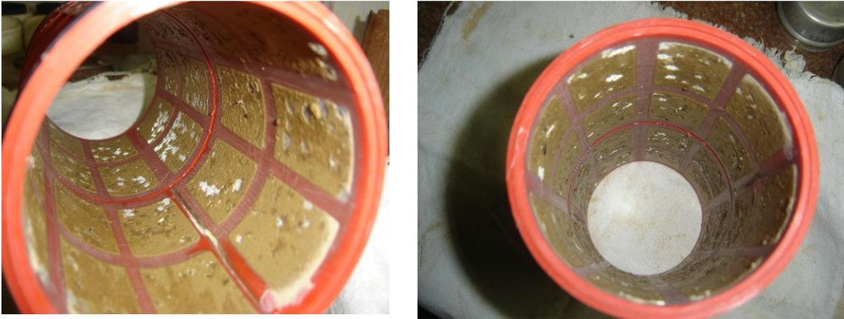
**Figura 6.** Filtro utilizado na primeira fase do ensaio com total obstrução por carbonatos (formação de “cake”).
