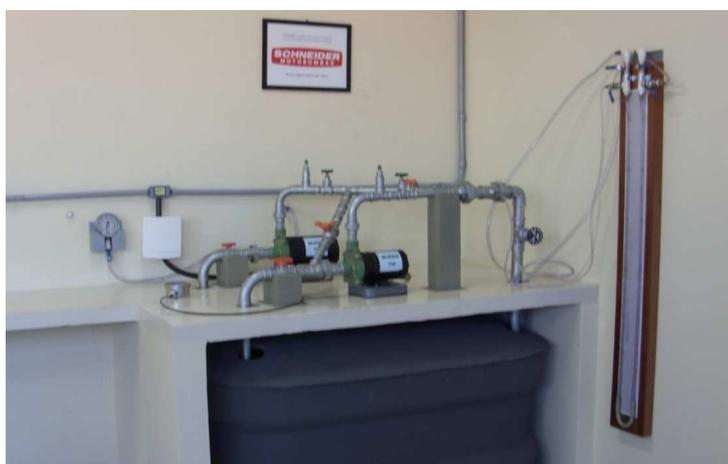
**Figura 1.** Bancada de ensaios de bombas centrífugas do Laboratório de Hidráulica e Irrigação da UEM/CAR, em Cidade Gaúcha/PR.
