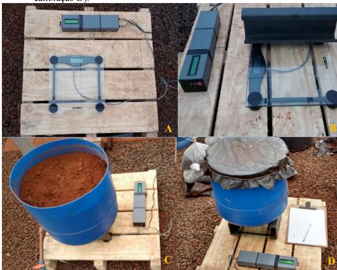
O condicionador de sinal também é usado para realizar o ajuste da tara. Os dados aquisitados pelo conversor de 12 bits são previamente gravados em uma memória ROM, até que sejam transferidos para um cartão SD, ao comando do operador. Um relógio em tempo real, provido de bateria própria, também é usado para evitar que a falta de energia interrompa ou perturbe o processo de aquisição, que poderá durar dias, conforme a programação estabelecida para a operação do sistema.
